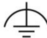
Anschluss des Schutz-Potenzialausgleichleiters
