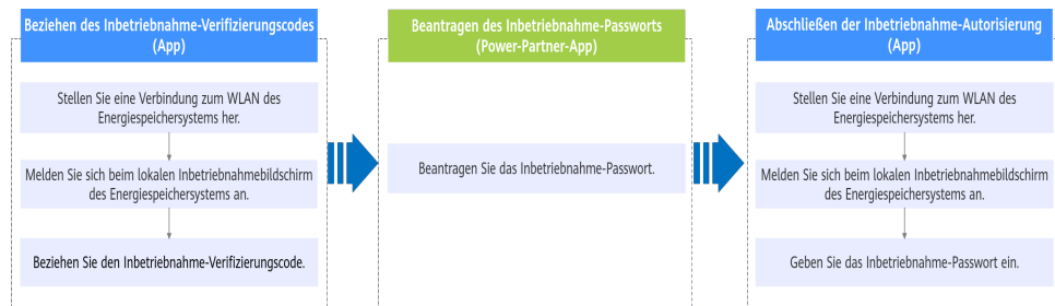
Abbildung 9-2 Verfahren zur Autorisierung der Inbetriebnahme des Energiespeichersystems
